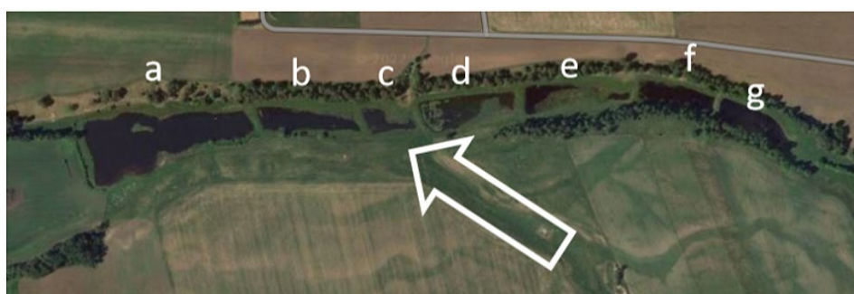
Figur 20. Våtmark VA14 bestod av sju sammankopplade dammar (a–g), där g är den första dammen högst upp i systemet. En kraftig sluttning ner från jordbruksfältet visas med vita pilen.
