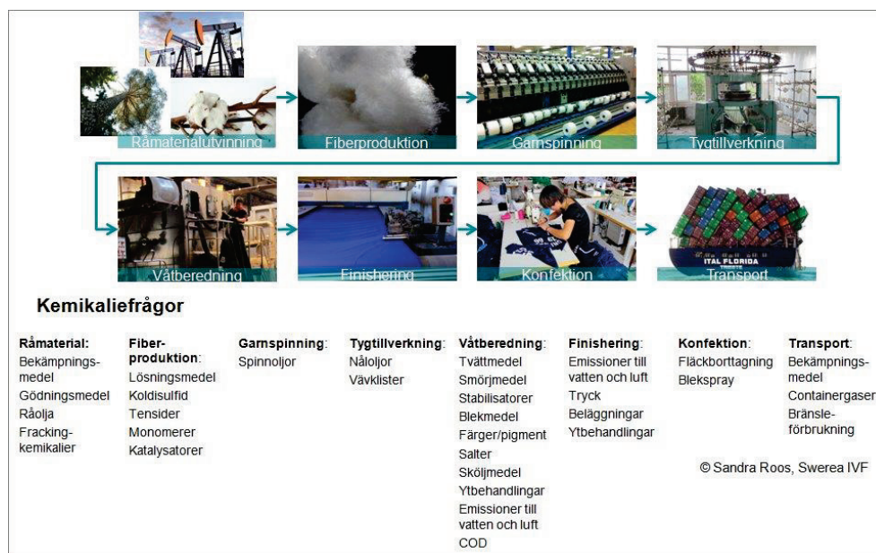
Figur 18: Visar de kemikalier som används för textilproduktionens olika faser samt kan tillsättas för att ge slutprodukten specifika funktionsegenskaper och som ett stöd under den textila tillverknings[83].
