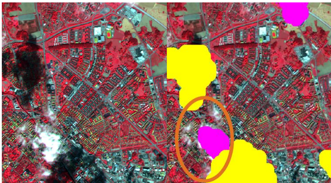
Figur 11. Bilden till höger visar en mask med moln (rosa) och molnskuggor (gult) som överlagrar satellitdata. Inom det inringade området till vänster visas ett område där man behöver komplettera med manuell molnmaskning.
