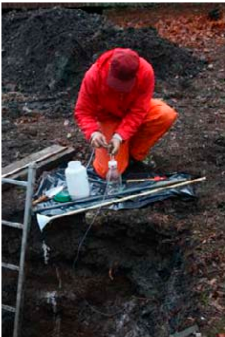
Figur 12. Markvattenprovtagare IVL Tö 2:55
