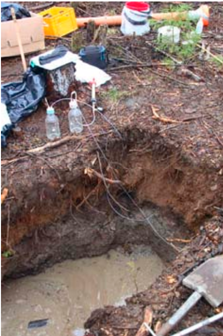
Figur 20. Installerade markvattenprovtagare i IVL Gr 1. Figur 21. Installation av grundvattenrör i IVL Gr 1.
