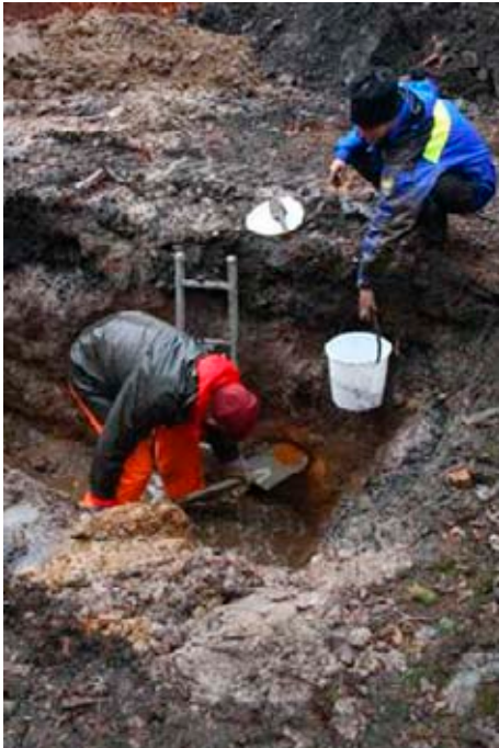
Figur 10. Provtagning av jord IVL Tö 2:100-110
