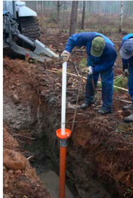
Figur 20. Installerade markvattenprovtagare i IVL Gr 1. Figur 21. Installation av grundvattenrör i IVL Gr 1.
