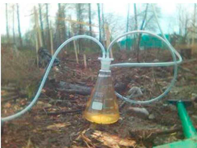
Figur 26. Grundvatten i Grimstorp, gulaktig färg med doft av kreosot.
