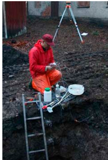
Figur 13. Markvattenprovtagare IVL Tö 2:20
