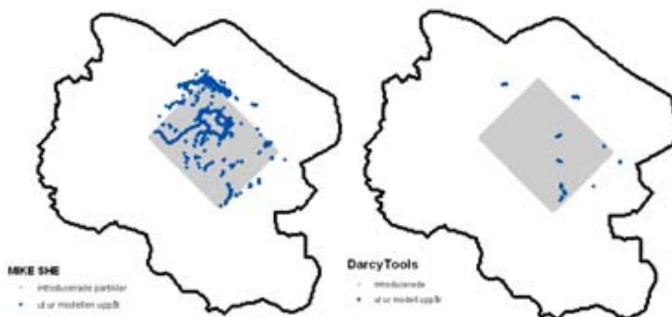
Figur 6-10. Jämförelse av slutdestination för partiklar som nått de övre jordlagren efter 1000 år. Darcy Tools med fast grundvattenyta (F1) och MIKE SHE med fast grundvattenyta (F2a). Det grå området visar det område där partiklarna introducerades på nivån -400 möh.
