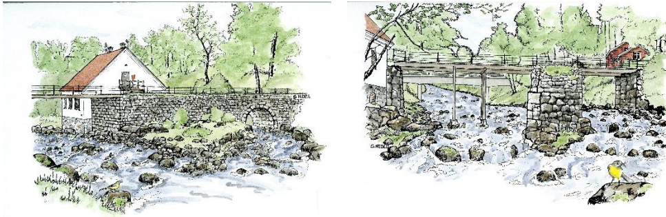
Figur 12. Illustrationer av partiell utrivning av Järle Kvarn, nedströms vy till vänster, uppströmsvy till höger. Norconsult 2016.
