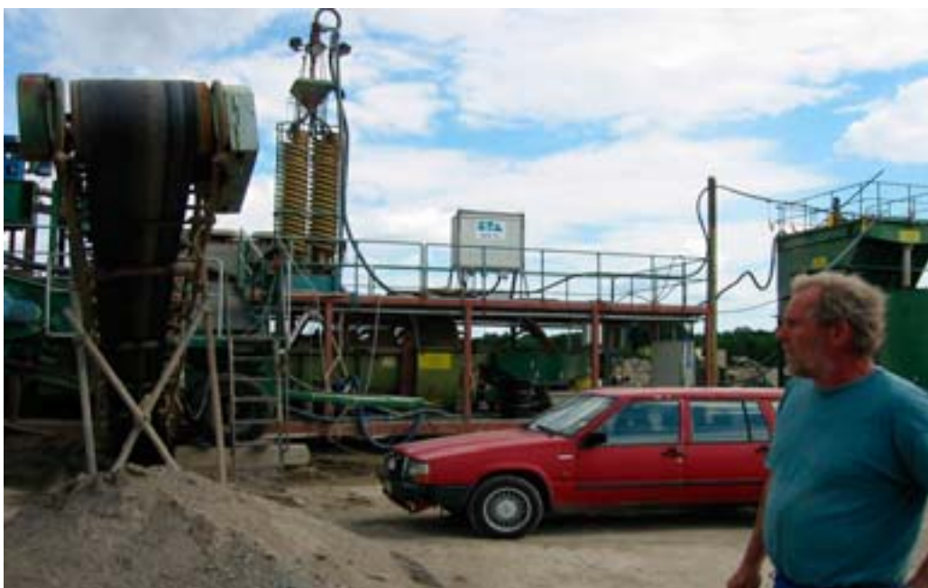
Figur 3-3: Jordtvättanläggning för behandling av blyhaltig kulfångssand vid P10, Strängnäs (Källa: Svensk Sjömuddring AB och Johan Helldén AB)
