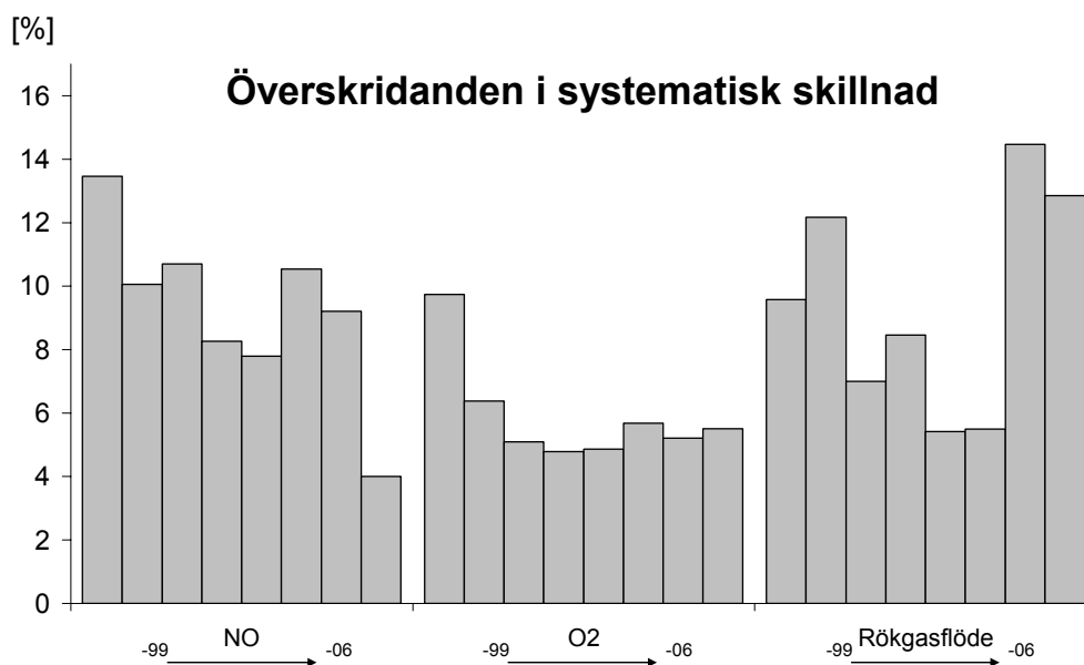
Figur 8: Överskridanden i systematisk skillnad för NO, O 2 och rökgasflöde vid jämförande mätningar åren 1999-2006 (stigande åt höger i varje kategori), andelar i %.
