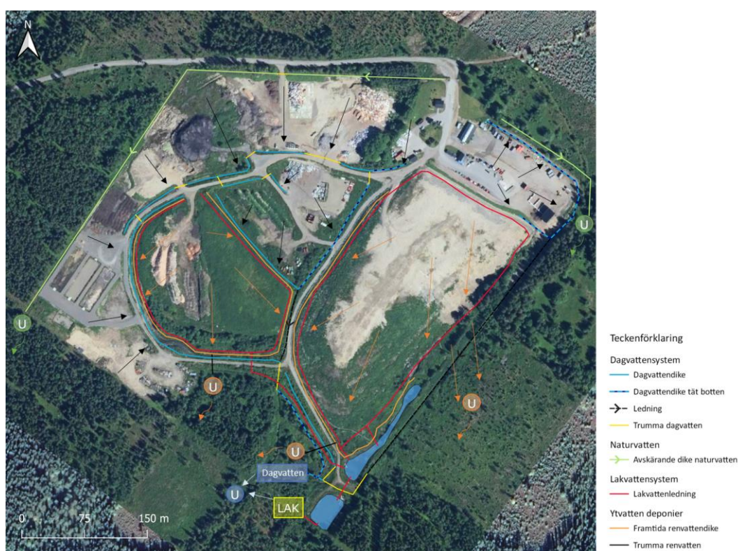
Figur 1 Övergripande skiss över de olika systemen som föreslås för omhändertagande av olika typer av vatten som uppkommer inom Liden avfallsanläggning.
